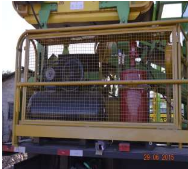
INCLUSÃO DE COMPRESSOR E BOMBA DE GRAXA
