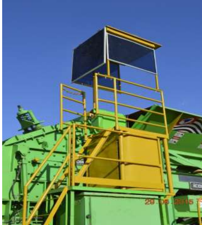
ALTERAÇÃO DA PLATAFORMA DO OPERADOR COM INSTALAÇÃO DE PROTEÇÕES (SUPERIOR)
